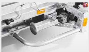
**Stabiler Schutzbügel** bietet sicheren seitlichen Anfahrerschutz und Aufstiegshilfe.
