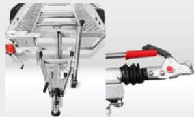
**V-Deichsel & Anhängung** Robuste, geschraubte V-Deichsel und massive Gusskupplung (nur bei 3500 kg Ges.-Gew.).
