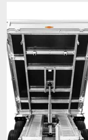
**Schieneablage in der Unterbrücke** ermöglicht durch das Nachrüsten von Schienenwinkelprofilen (Zubehör) einen einfachen und sicheren Transport von Auffahrschienen (Zubehör).
