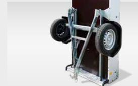
**Platzsparende Lagerung** durch Abklappen der V-Deichsel.
