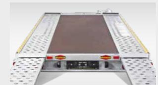
**Siebdruckbodenplatte** für eine geschlossene Oberfläche. Ideal zum Transport von Fahrzeugen, die Flüssigkeit verlieren.
