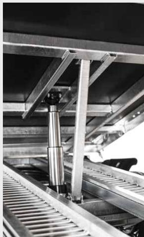
**Sicherungsstütze** sichert die Oberbrücke und verhindert ein Absinken im Wartungsfall.
